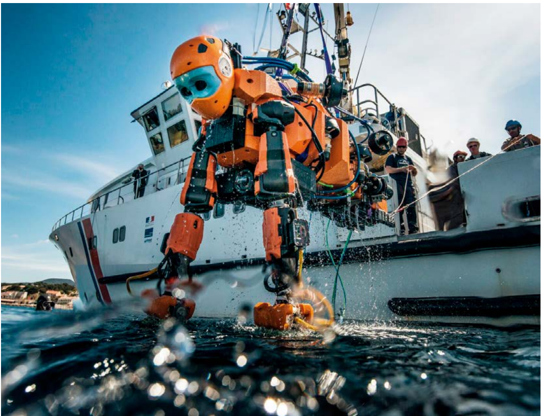
図2 フランスの国立研究所を中心に開発中の水中考古学専用人型ロボット
